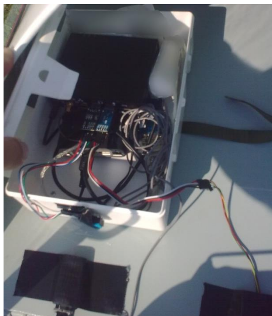
Obrázek 3 - Ukázka testovacího zapojení Integrovaného záznamníku letů
